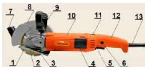
1-диск алмазный; 2-основание; 3-маслёнка; 4-крышка электрической щётки; 5-выключатель; 6-фиксатор выключателя; 7-адаптер пылесоса ; 8-кожух защитный; 9-D-рукоятка; 10-корпус двигателя; 11-кнопка фиксации задней рукоятки; 12-задняя рукоятка; 13-сетевой кабель
