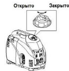
Рис.4 Воздушный клапан крышки бензобака
