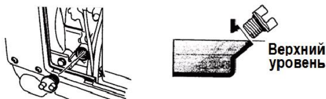
Рис.6 Заправка генератора маслом
