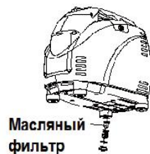
Рис.11 Очистка масляного фильтра
