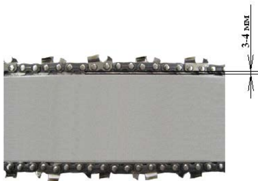
Рис. 5. Регулировка натяжки цепи
