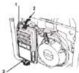
Рис.8. Снятие воздушного фильтра
