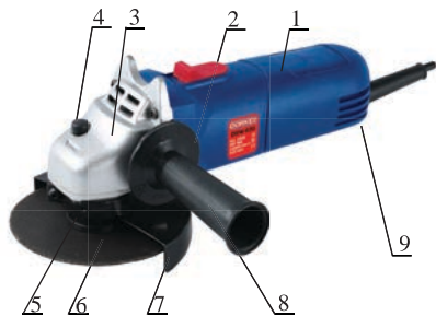
1- корпус; 2- выключатель; 3-корпус редуктора; 4- фиксатор шпинделя; 5- фланцевая шайба; 6-зажимная гайка; 7-кожух защитный; 8-рукоятка дополнительная; 9-венти- ляционные каналы.
