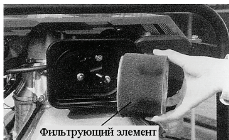
Рис.11. Обслуживание воздушного фильтра
