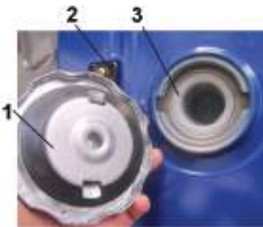
Рис. 2. Топливный бак 1- крышка топливного бака 2- указатель уровня топлива 3- фильтр
